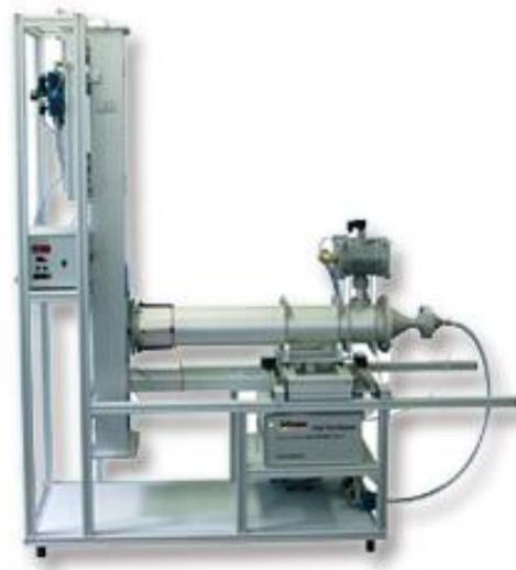
图 8 过滤材料性能试验台
